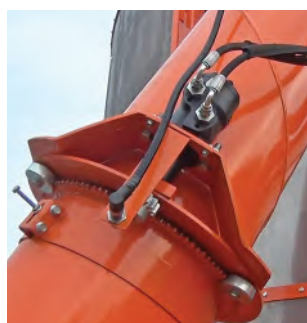
Hydraulic motor for swiveling cap driving Гідравлічний мотор приводу верхньої рухомої частини пристрою вивантаження
