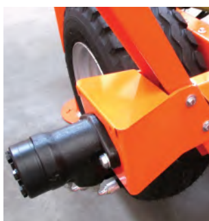
Hydraulic motor for recycling gate driving Гідравлічний мотор засувки рециркуляції
